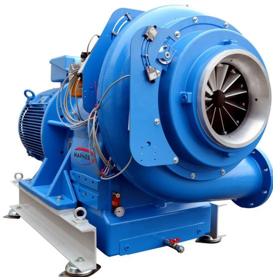
Modelo mostrado con configuración de motor con brida B5
